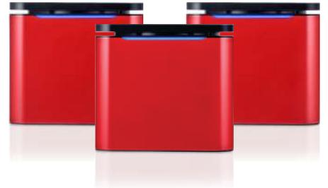
Ne perdez plus jamais de données à cause de déconnexions. Chaque Mic est doté d'un système de stockage de données intégré qui protège vos données même si le PC est déconnecté. La récupération est automatique dès que la connexion est établie.
